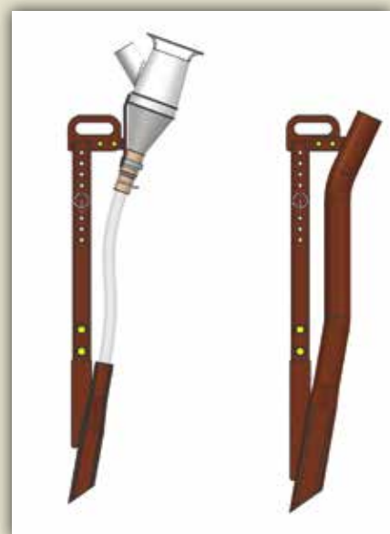
Dos rejas distintas para la incorporación del abono. Una para abono granulado y una segunda para la inyección de purines (60mm).
